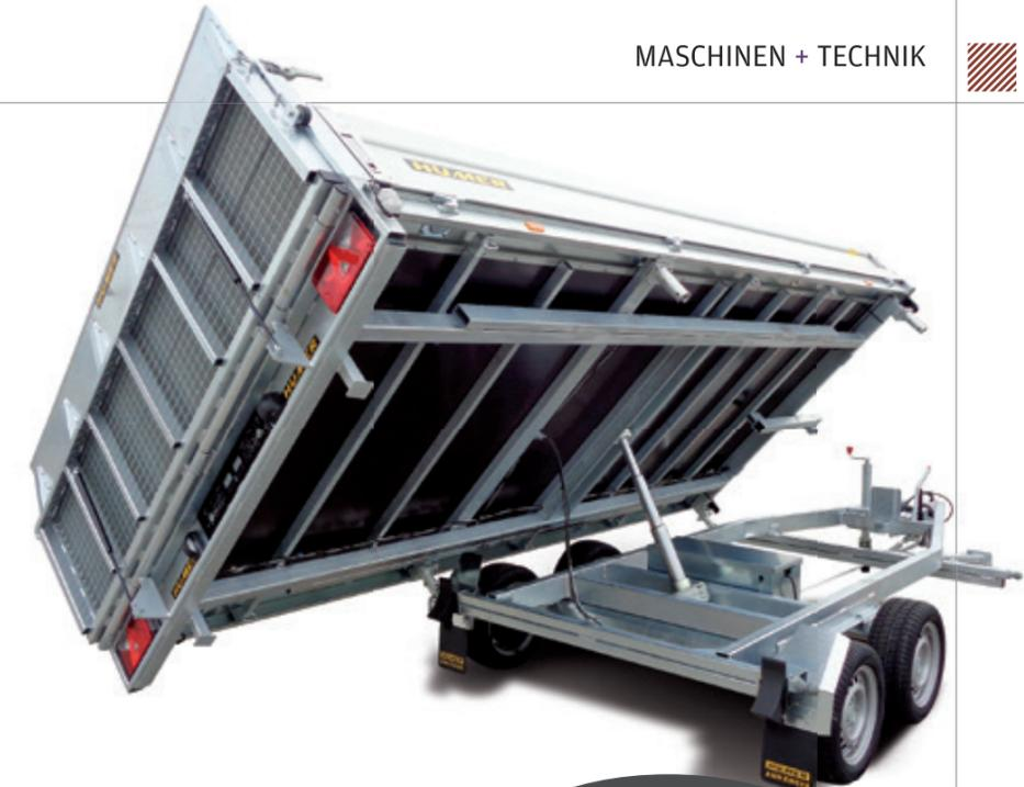
dreiseitig abklappbaren und abnehmbaren Bordwänden im Aluminium-Hohlprofil sowie mit einer 13 pol. Beleuchtung, Stecker und Rückfahrcheinwerfer.
