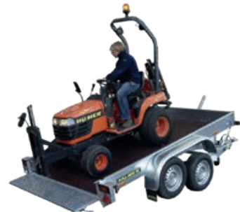
UNIVERSAL- TRANSPORTER - UT Räder neben der Ladefläche, kippbare Ladefläche
