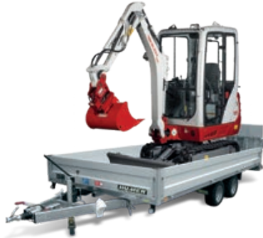
PRITSCHEN- HOCHLADER - LKP Räder unter der Ladefläche, kippbare Ladefläche
