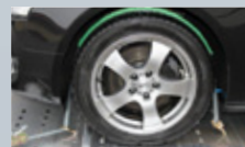
736143 Zurrgurt 3-Punkt, für Kässbohrersystem, 1500daN
