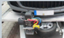
741701 Elektroseilwinde 4,3to, mit Nato-Steckdose*
