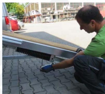
Vor und nach dem Nachspannen der Feder muss das Spaltmaß geprüft werden. Prüfen Sie mittels einer Fühlerlehre an mehreren Stellen der Feder das Spaltmaß. Sollte die Feder ein Spaltmaß von 1 bis 1,5 mm aufweisen, muss die Feder bei der nächsten Inspektion getauscht werden. Bei einem unterschreiten von 1 mm Spaltmaß ist der Austausch der Feder notwendig. (Des Federhebewerk und die Gewindespindel könnten beschädigt werden.)
