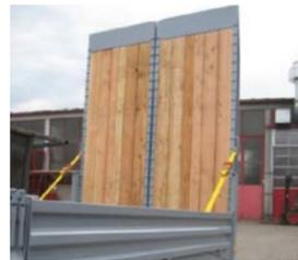
Zwingend erforderlich bei: schweren Rampen, wie geteilten Rampen überbreiten und überlangen Sonderrampen.
