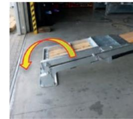
Auffahrtsrampe ablassen, Sicherung lösen und aufklappen. **Nicht fallen lassen!**
