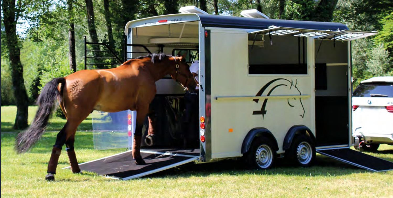
Gesicherter Ausstieg, breite Frontausstiegsrampe Richtung Ausgang
