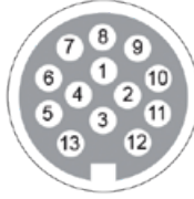
13-poliges System DIN / ISO 11446
