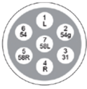
7-poliges System DIN / ISO 1724
