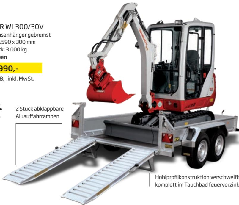
Hohlprofilkonstruktion verschweißt und komplett im Tauchbad feuerverzinkt
