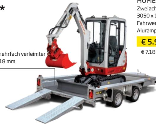
Ladefläche aus mehrfach verleimter Siebdruckplatte 18 mm
