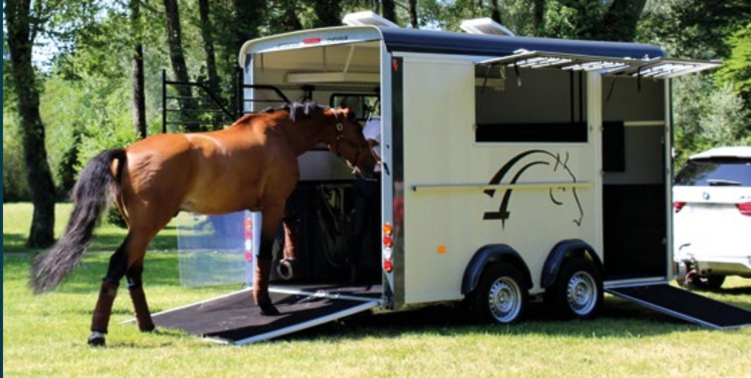
Gesicherter Ausstieg, breite Frontausstiegsrampe Richtung Ausgang
