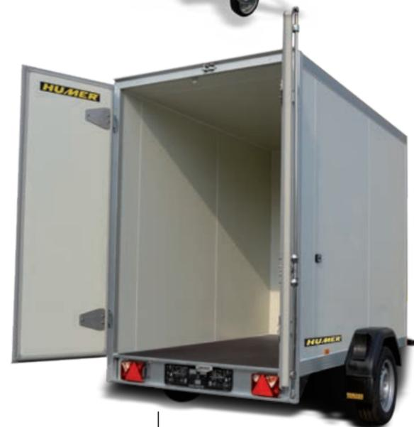
mehrfach verleimte Siebdruckplatte, 18 mm
