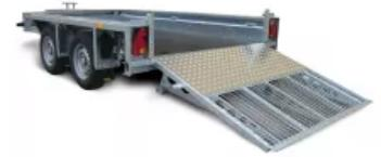
Die Unterseite des Trailers besteht aus einem verzinkten Stahl Fahrgestell und verzinkten Stahlachse für lang anhaltenden Korrosionsschutz.
