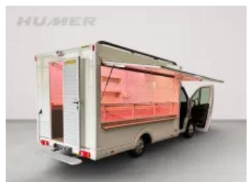
PU-Gießboden im Innenraum, Lichtgrau mit Antirutsch-Einstreupartikeln in Grau/Weiß/Schwarz Fahrerhausanschluss mit Durchgangstüre
