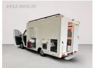
Einbaukasten für Kühlmaschine mit belüfteter Außenklappe, durchgehende Wandarbeitsplatte, Radkastenumbauung
