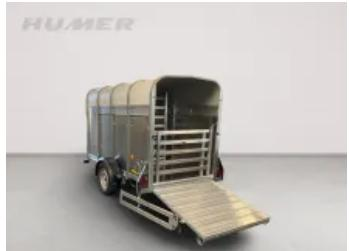
Hänger sind mit einer einzelnen Starrachse, Parabelfederradaufhängung und Fahrgestell ausverzinktem STahl ausgestattet.
