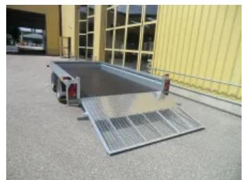
Die Unterseite des Trailers besteht aus einem verzinkten Stahlfahrgestell und verzinkten Stahlachsen für lang anhaltenden Korrosionsschutz.
