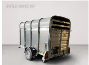
Hänger sind mit einer einzelnen Starrachse, Parabelfederradaufhängung und Fahrgestell ausverzinktem STahl ausgestattet.
