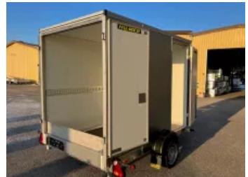
HUMER-LIFTOMAT Absenkanhänger mit Kofferaufbau Stahlblechsandwich
