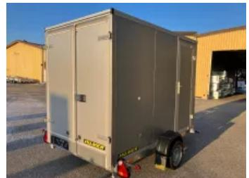
HUMER-LIFTOMAT Absenkanhänger mit Kofferaufbau Stahlblechsandwich
