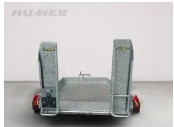
Phenolbeschichtet auf beiden Seiten, bieten unsere Sperrholzboden einen guten Rutschschutz.
