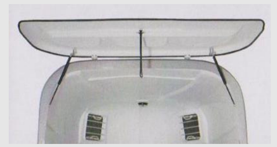
Durch Windflapp eine Durchgangshöhe von 232 cm
